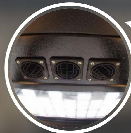
Для комфортной работы в машине установлен вентилятор-пылеотделитель со сменным фильтром, предотвращающий попадание пыли в кабину.
