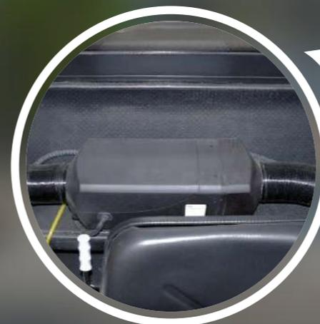
В машине установлено автономное отопление, которое позволяет поддерживать комфортную температуру в кабине в холодный период.
