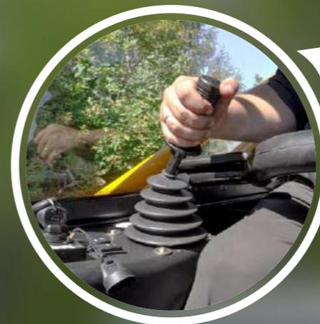
Эргономичное и удобное расположение чувствительных джойстиков обеспечивает простое и точное управление мини-погрузчиком. Для безопасной работы оператора установлена защитная дуга, при подъеме которой блокируется вся работа МКСМ.
