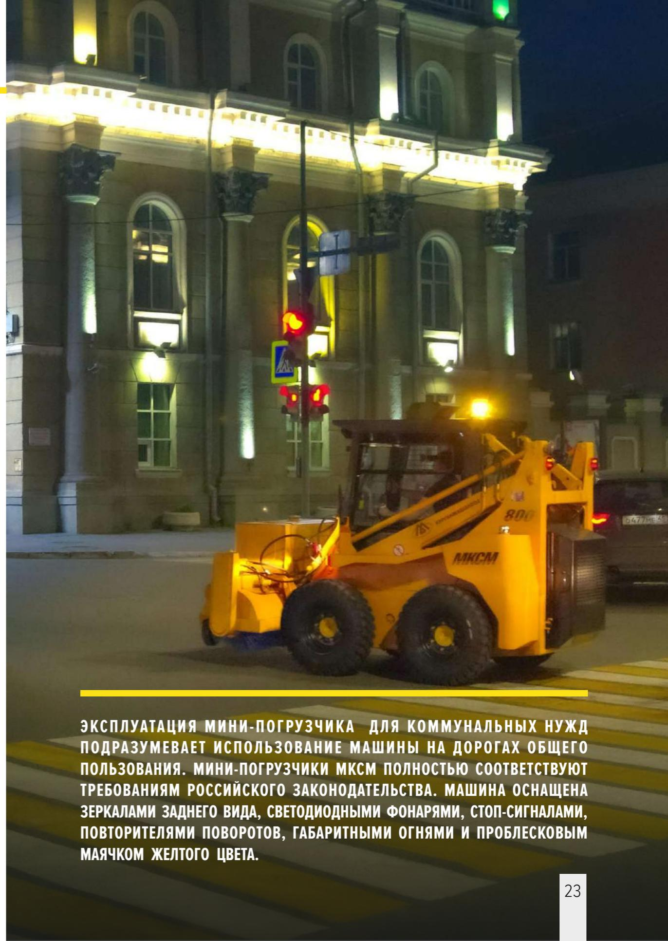
**ЭКСПЛУАТАЦИЯ МИНИ-ПОГРУЗЧИКА ДЛЯ КОММУНАЛЬНЫХ НУЖД ПОДРАЗУМЕВАЕТ ИСПОЛЬЗОВАНИЕ МАШИНЫ НА ДОРОГАХ ОБЩЕГО ПОЛЬЗОВАНИЯ. МИНИ-ПОГРУЗЧИКИ МКСМ ПОЛНОСТЬЮ СООТВЕТСТВУЮТ ТРЕБОВАНИЯМ РОССИЙСКОГО ЗАКОНОДАТЕЛЬСТВА. МАШИНА ОСНАЩЕНА ЗЕРКАЛАМИ ЗАДНЕГО ВИДА, СВЕТОДИОДНЫМИ ФОНАРЯМИ, СТОП-СИГНАЛАМИ, ПОВТОРИТЕЛЯМИ ПОВОРОТОВ, ГАБАРИТНЫМИ ОГНЯМИ И ПРОБЛЕСКОВЫМ МАЯЧКОМ ЖЕЛТОГО ЦВЕТА.**
